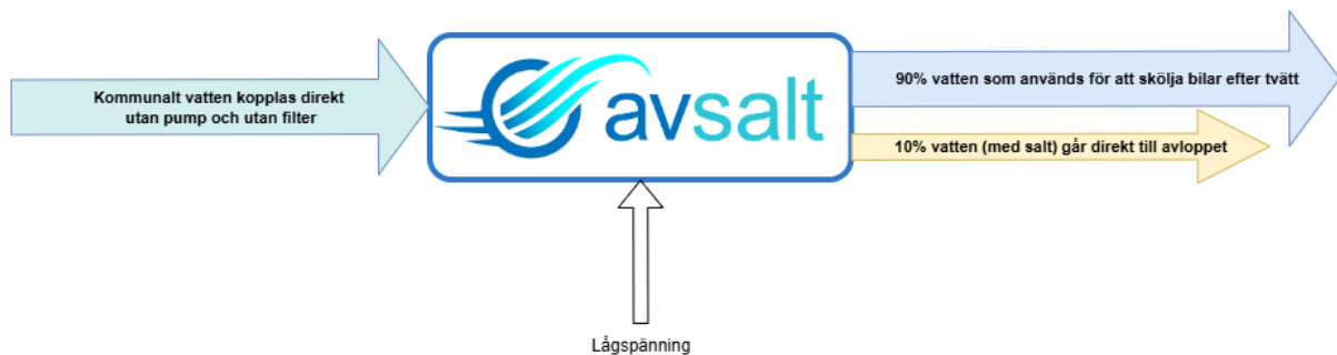
Figur 2: Konceptuell funktion av Avsalts tilltänkta produkt för biltvättar.
